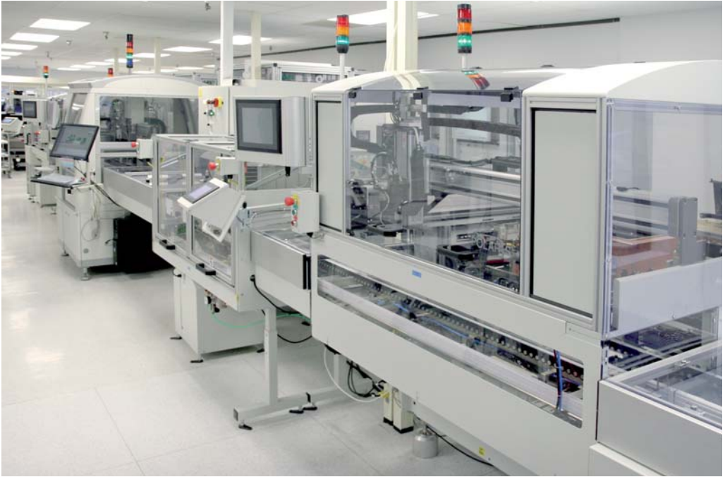
Vollautomatische Testlinie für implantierbare Geräte
